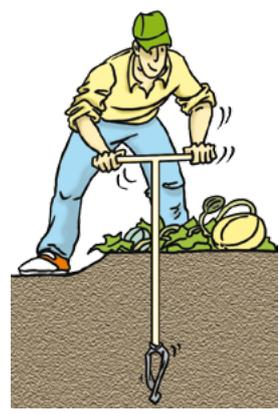
**La tensiométrie** : Technique recommandée pour mesurer la disponibilité de l'eau dans le sol. Elle met facilement en évidence les excès ou les manques d'eau. Elle tient compte de la situation réelle du sol.
