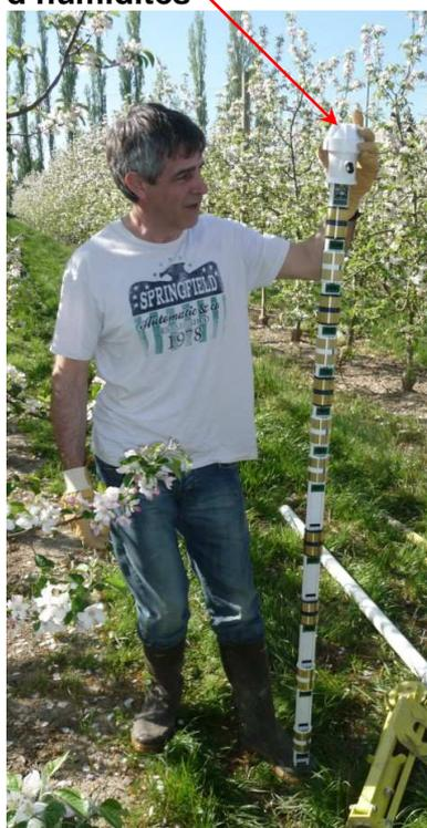
Les capteurs d'humidité ont été fixés à diverses profondeurs :
